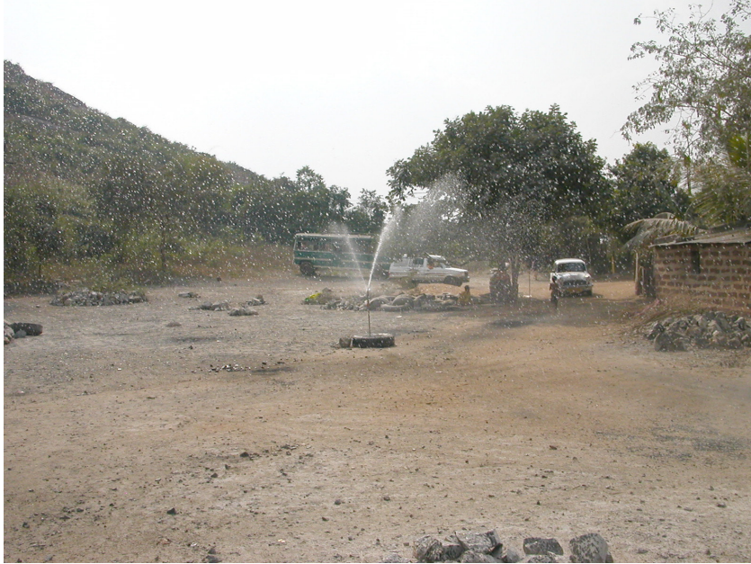
ಚಿತ್ರ ೮: ರಸ್ತೆಗುಂಟ ಹಾಕಲಾಗುವ ಈ ರೀತಿಯ ಮೊಬೈಲ್ ಸೀರ್ಪಣೆಗಳು ಕಲ್ಲತ್ತು ಯಂತ್ರದ ಮಿಲ್ಲಿನ ಬಳಿ ನಿತ್ಯ ನೂರಾರು ಬಾರಿ ಬಂದು ಹೋಗುವ ಲಾರೊಗಳಿಂದ ಏಳುವ ಧೂಳನ್ನು ಸಮರ್ಪಕವಾಗಿ ನಿಗ್ರಹಿಸಬಲ್ಲವು.
